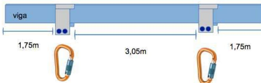
Mosquetão de rosca diâmetro 10 a 12mm para evitar danos à corda. Carga de ruptura aberto: 900kg
