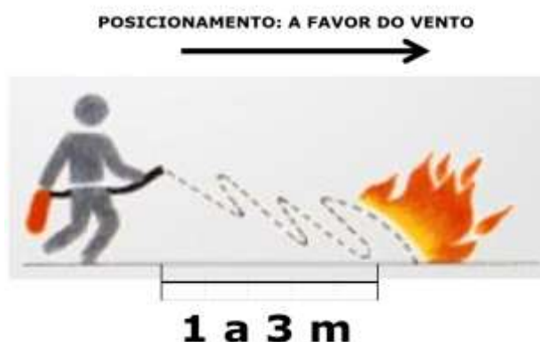
Figura 10 – Instruções para aplicação do extintor (a ser operado e acionado apenas por pessoas treinadas e capacitadas).
