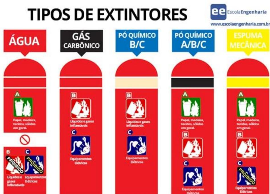
**Figura 8:** Tipos de extintores de incêndio. PEREIRA, Caio. Escola Engenharia, 2017.
