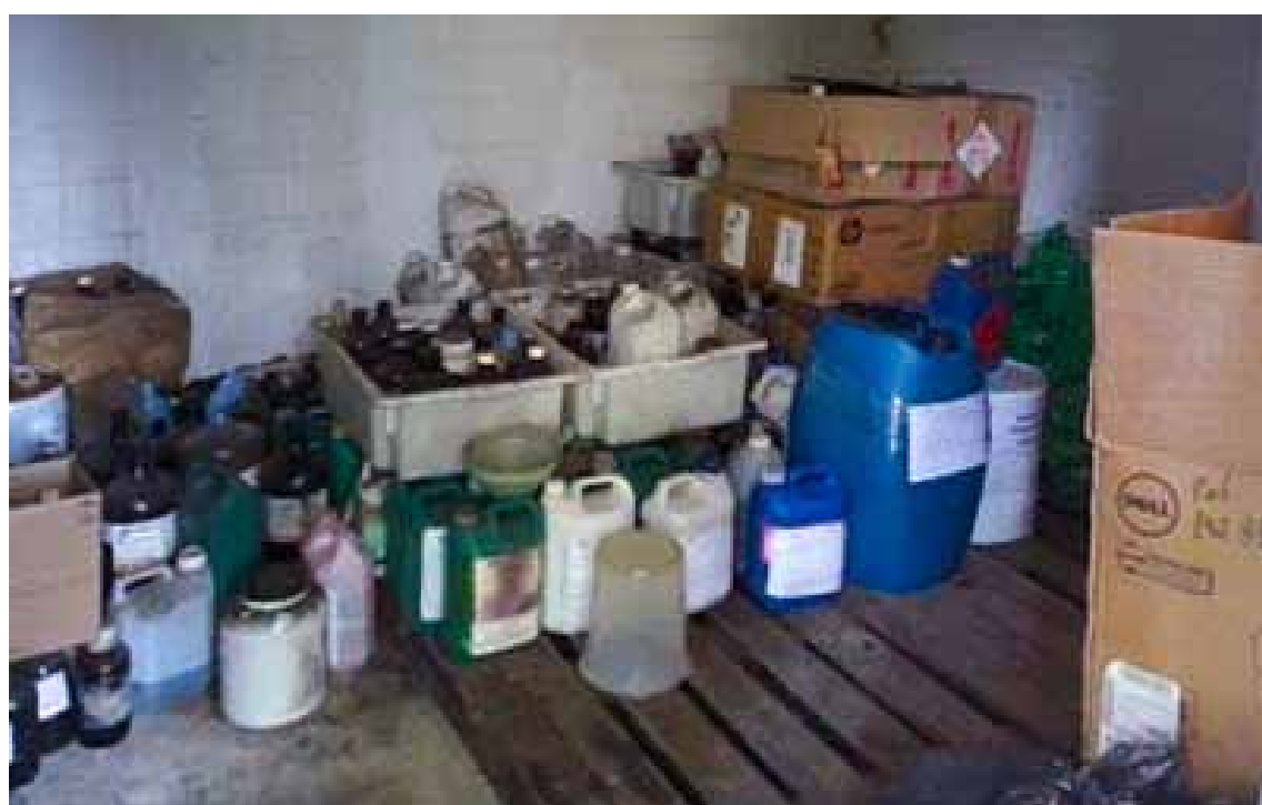
Imagem 5.3.22: Recipientes armazenados de forma desorganizada. Fonte: levantamento fotográfico realizado pela consultora.
