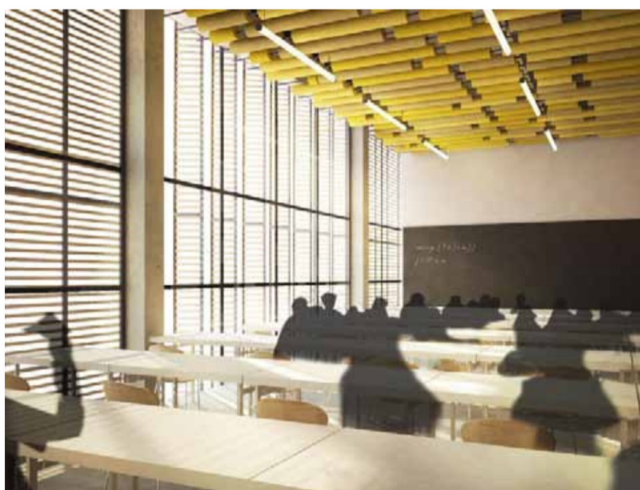
Figura 3.95: Elementos de proteção acústica em salas de aula. Fonte: Concurso para o campus Cabral da UFPR – Studio Arthur Casas – 1º Lugar
