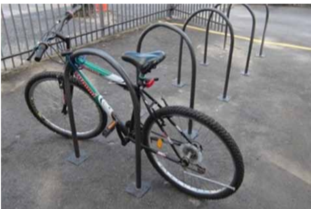
Imagem 9.21: Suporte modelo "U invertido"; Fonte: ACBC, 2013.
