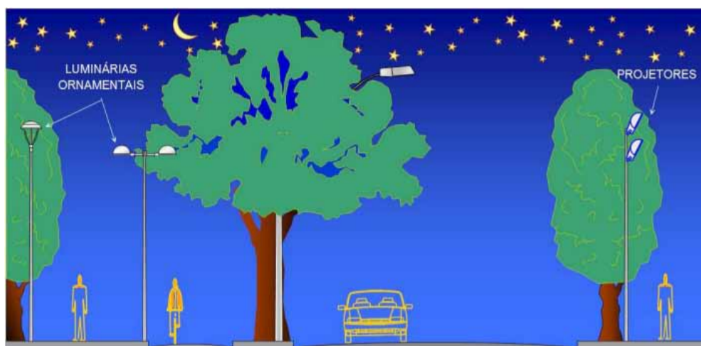
Figura 9.8: Projetos específicos de iluminação pública de passeios em áreas com intensa arborização; Fonte: CEMIG, 2012.
